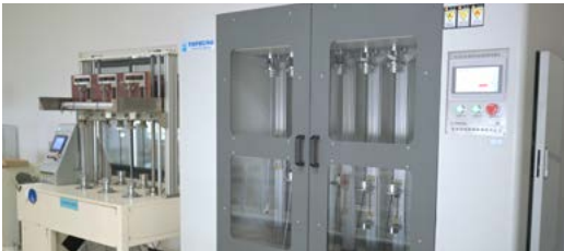
扭转试验说明 固定距离: 0.5m; 扭转角度: \pm 180^\circ 吊重: 500g; 速度: 60 次 / 分钟
