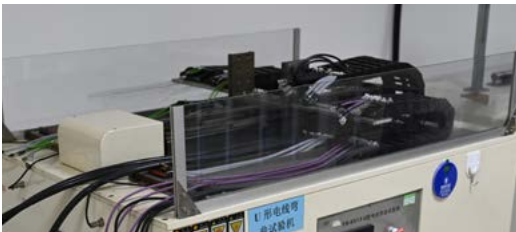
拖链试验说明 拖链行程: 0.6m; 弯曲半径: 50mm; 速度: 60 次 / 分钟
